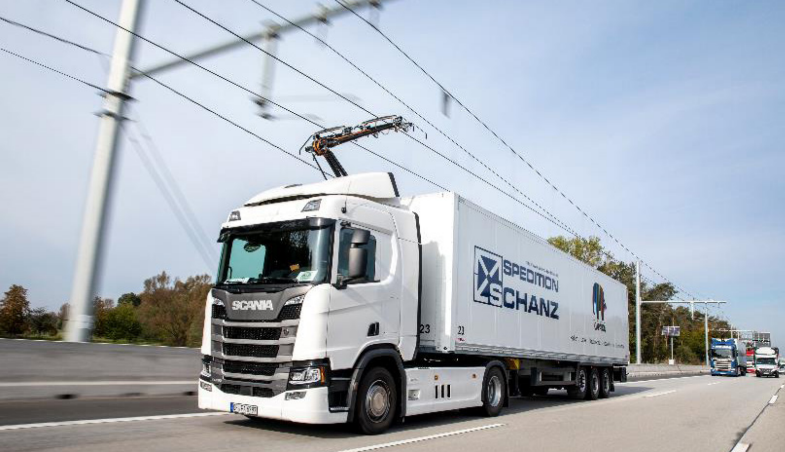
Photo 6 : Poids lourd hybride roulant sur l'eHighway près de Darmstadt (Allemagne). Source : Siemens.
