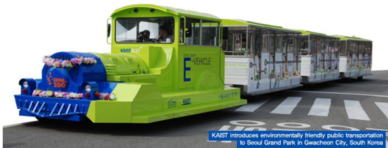
Figure 7 : Petit train rechargé par induction en roulant dans un parc à Séoul – KAIST.
