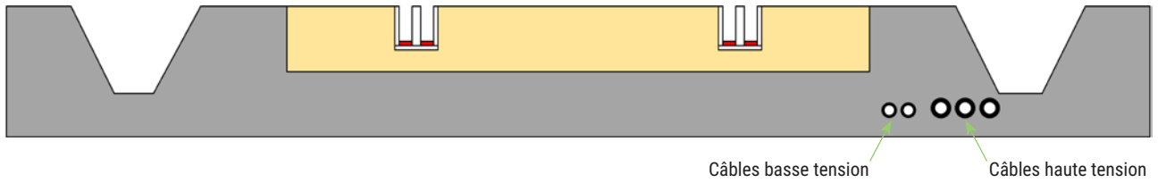
Figure 5 : Coupe de la chaussée équipée d'un double rail Elways. Ces rails sont alimentés à partir des câbles basse-tension qui assurent la commutation rapide entre segments. Les câbles basse-tension sont eux-mêmes alimentés à partir du câble haute tension. Source : Elways.
