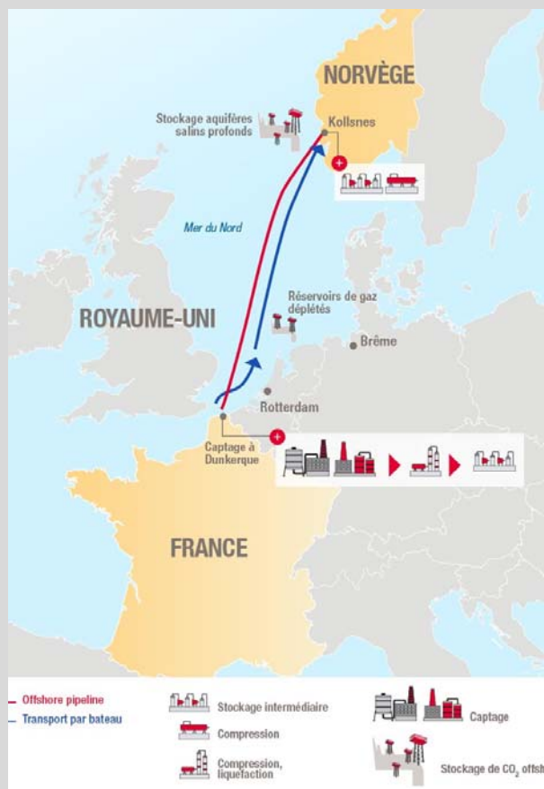
Figure 11 : Acheminement du CO 2 collecté à Dunkerque vers un site de stockage en mer du Nord – Source : TotalEnergies.
